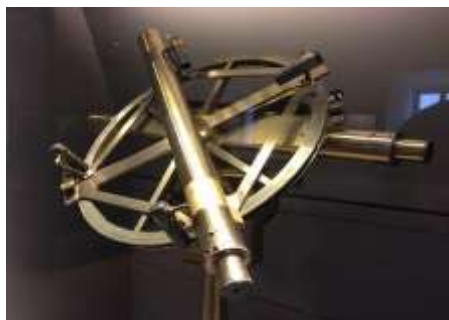
Cercle répétiteur de Borda et Lenoir pour mesurer les angles
